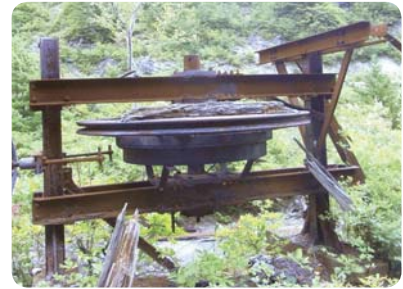
⑦旧沼尻鉾山で硫黄鉾運搬に使用していた索道巻上滑車
